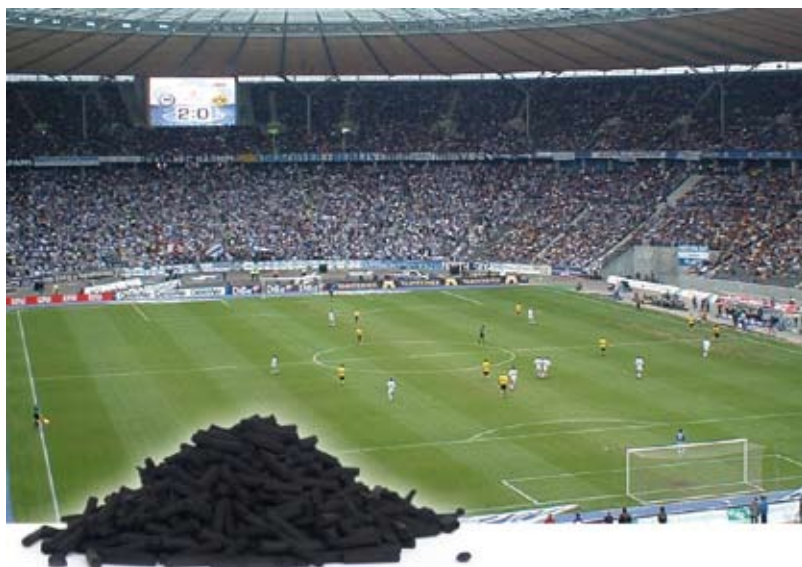
Die innere Oberfläche von 6 Gramm hochwertiger Aktivkohle nimmt etwa die Fläche eines Fußballfeldes ein.
